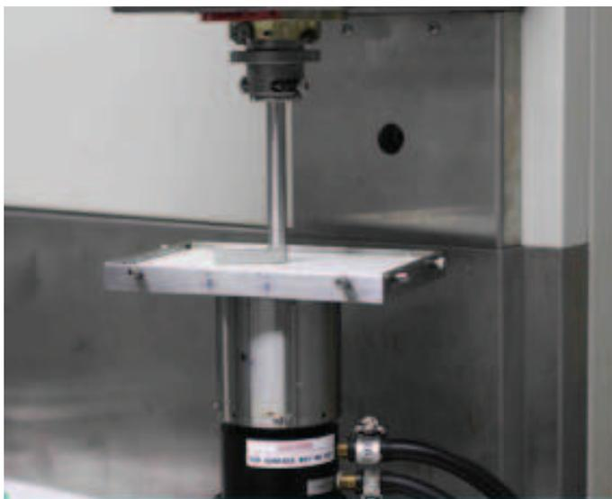
Figura 3.13: Equipamento para medir a aderência da parafina montado no reômetro.
