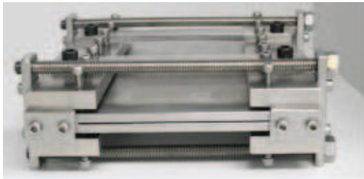
Figura 3.9: Seção de testes com placas inox sem revestimento.
