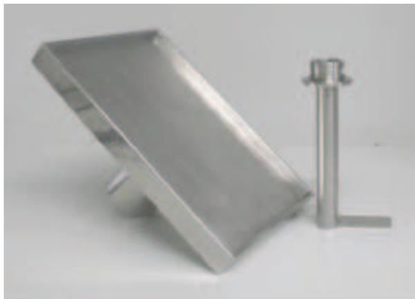
Figura 3.12: Equipamento para medir a aderência da parafina – Copo e Bob.
