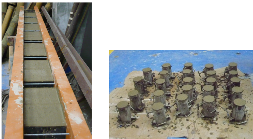
Figura 3.3 – Detalhe da concretagem dos blocos e dos corpos-de-prova.
