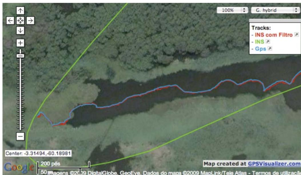
Figura 11 – Corte 2 da Ampliação do Mapa Geo-Referenciado das posições do Filtro de Kalman, do INS e do GPS nos testes na Amazônia
