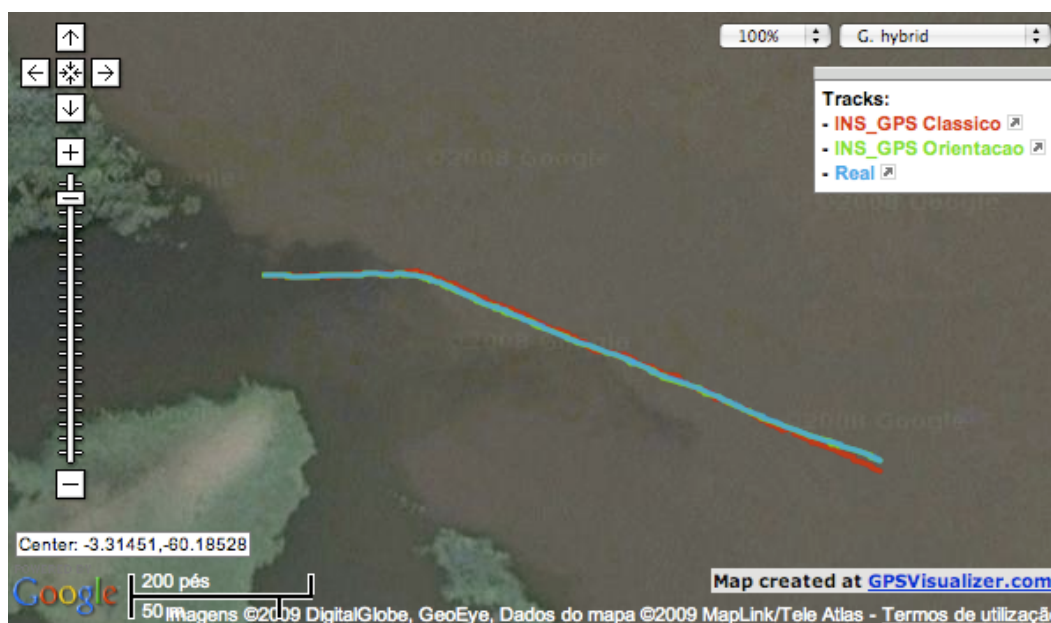
Figura 8 –Mapa Geo-referenciado do Percurso Calculado pela Fusão GPS/INS Clássica e com Orientação.
