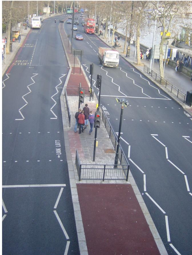
Figura 30 - Travessia em cidade inglesa onde o pedestre deve acionar o semáforo através de botoeira. As linhas em zigue-zague informam ao condutor que é um trecho de travessia para pedestre e onde não pode estacionar para não atrapalhar a visão do transeunte.
