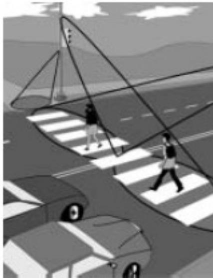
Figura 31 - Sistema automático de identificação de pedestre na calçada e na faixa de travessia de pedestres.
