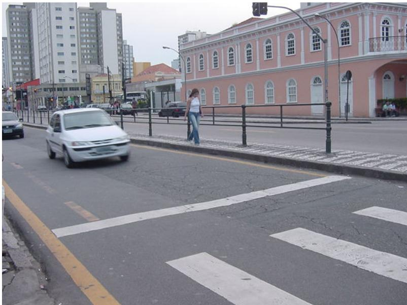
Figura 11 – O automóvel deverá parar antes da linha branca perpendicular ao sentido da via. Esta linha chama-se linha de retenção. Apesar de ser uma informação destinada ao condutor de veículo, o pedestre pode também tomar informação das condições de sua passagem ao perceber se os motoristas obedeceram ou não esta sinalização - Foto do autor. Local: Av. Sete de Setembro – Curitiba (PR).
