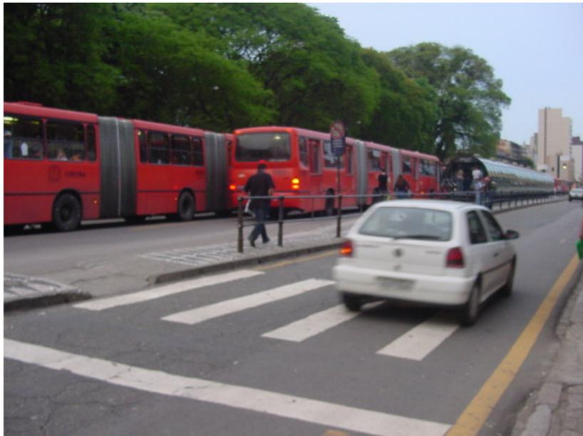
Figura 14 – Uma cerca colocada na calçada ao longo da via e só interrompida em frente a faixa de travessia de pedestres. O dispositivo de proteção contínua serve para dificultar a passagem do pedestre no trecho e estimulá-lo a passar em local com maior segurança - Foto do autor. Local: Av. Sete de Setembro – Curitiba (PR).
