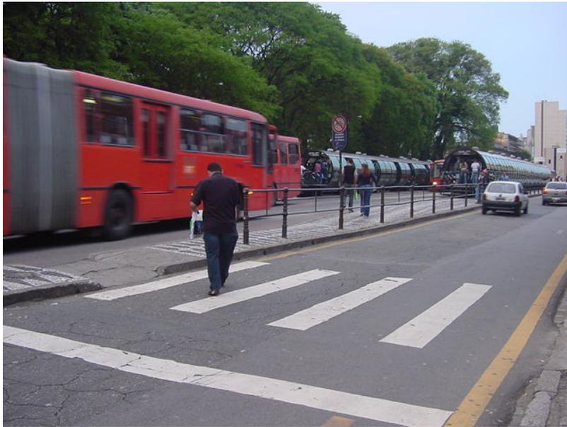
Figura 12 – Faixa de travessia de pedestres do tipo zebra. São várias faixas paralelas entre si e seguem a direção da via. Indicam que o pedestre deve passar sobre elas. O tipo zebra é o mais utilizado nas cidades brasileiras - Foto do autor. Local: Av. Sete de Setembro – Curitiba (PR).
