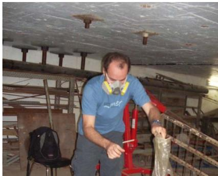
Figura 7 – Detalhe da colocação do solo contaminado na caixa de dessorção térmica
