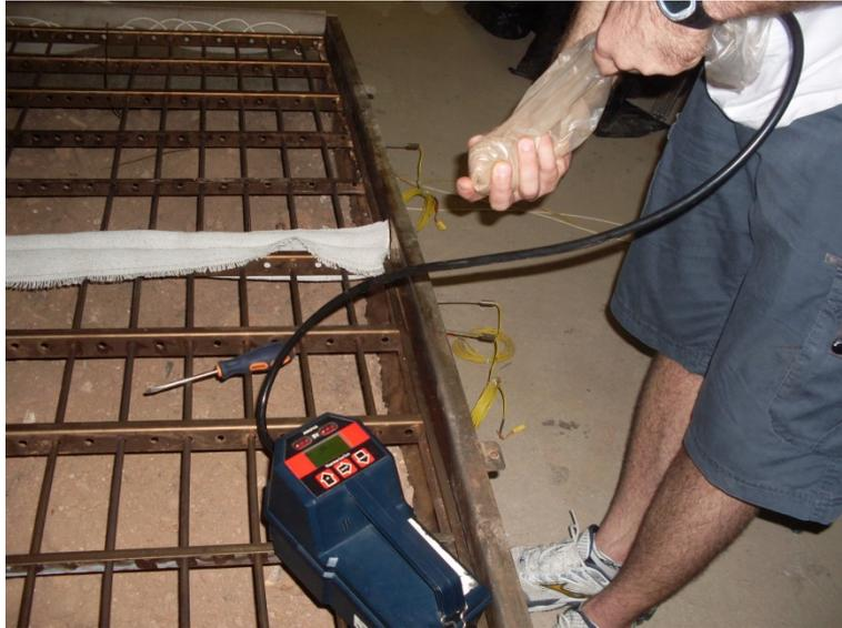
Figura 11–Determinação da concentração de TPH no solo tratado
