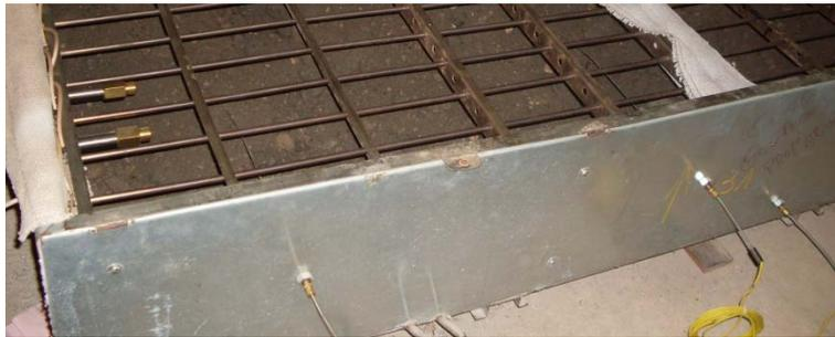
Figura 4 – *Layout* da instrumentação do ensaio: a) disposição espacial dos termopares e b) termopares instalados
