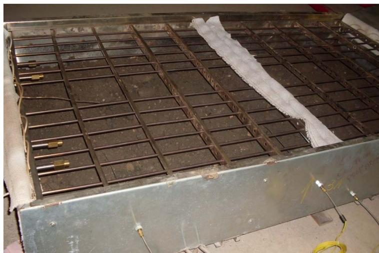
Figura 8 – Detalhe da instalação das mantas isolantes
