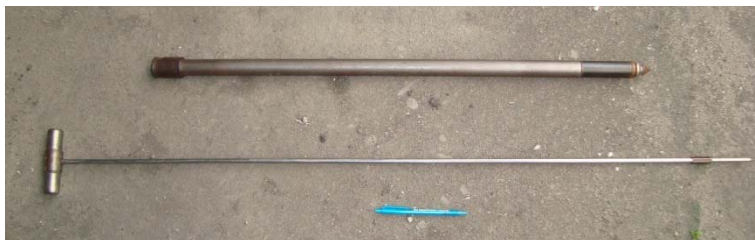
Figura 3 Detalhe do amostrador de gás
