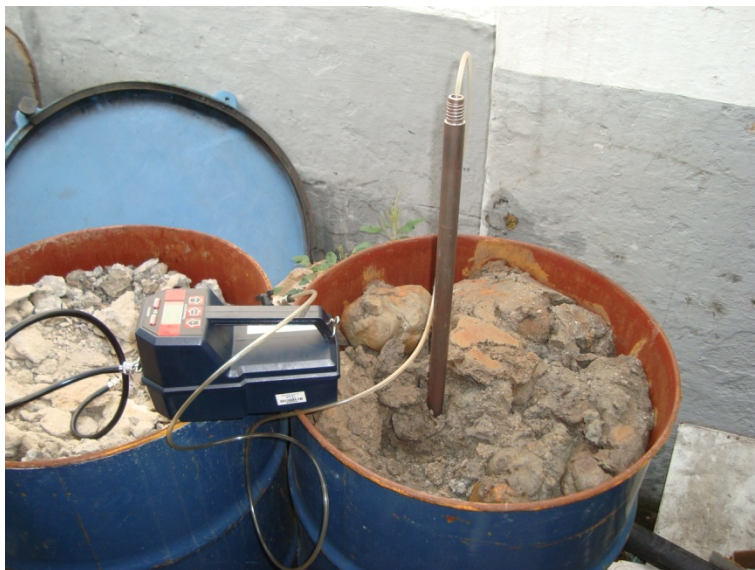
Figura 7 - Determinação de TPH nos materiais contidos nos tambores metálicos
