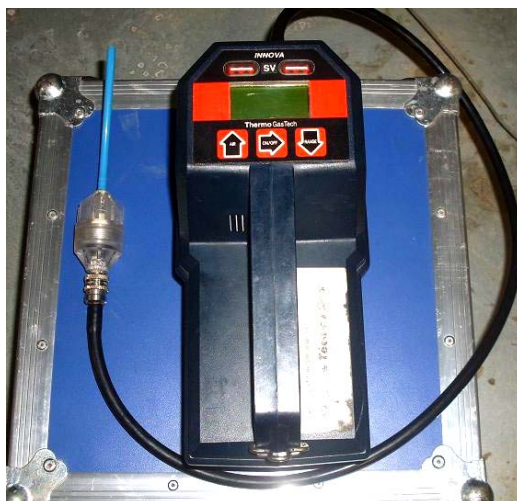
Figura 4 - Medidor de hidrocarboneto total de petróleo.
