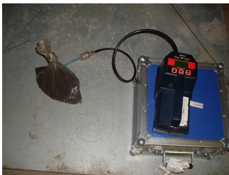
Figura 11 - Determinação do TPH na amostra contaminada utilizando o procedimento CETESB.
