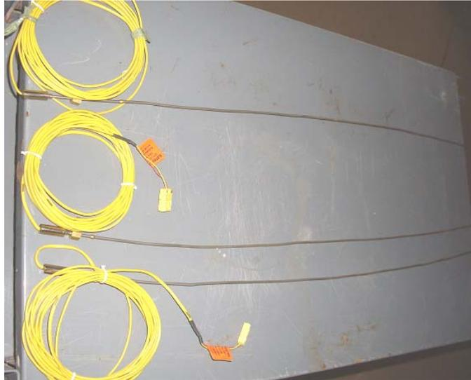
Figura 11 Termopares.
