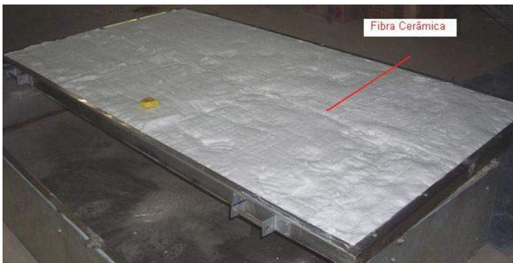
Figura 16 - Fibra cerâmica colocada dentro da tampa da Caixa térmica.
