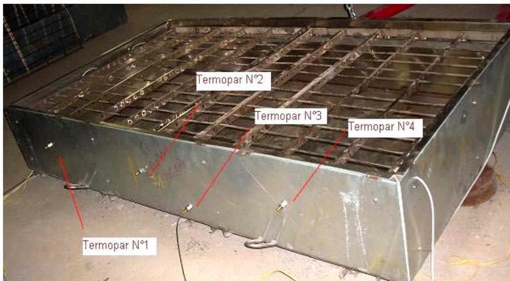
Figura 12 - Distribuição dos termopares na caixa térmica.
