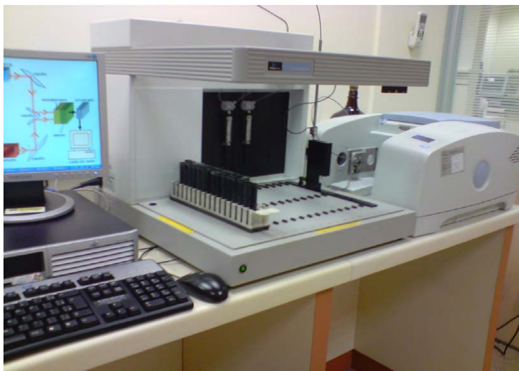
Figura 9 - Foto do autoamostrador Liquid Autosampler acoplado ao equipamento Spectrum 100
