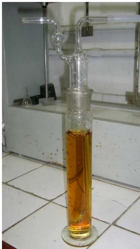
Figura 7: Lavagem da corrente gasosa que deixa o gerador de ozônio em solução de iodeto de potássio
