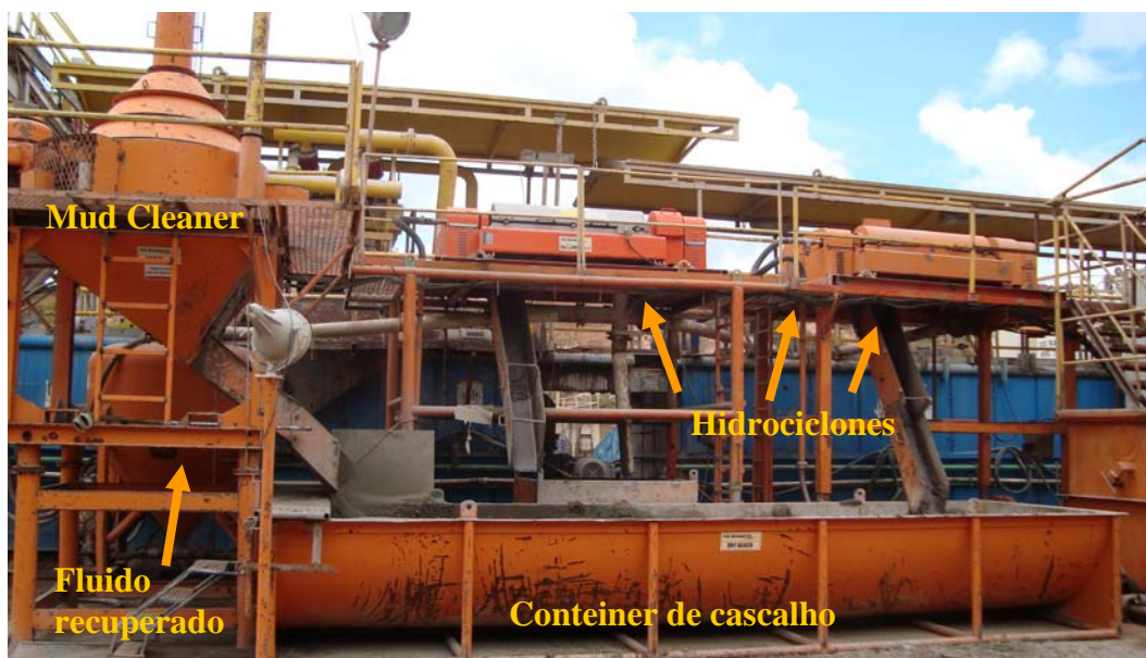
Figura 2-6 – Sistema de controle de sólidos da MI-Swaco.
