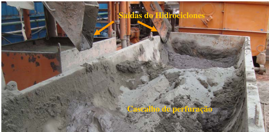
Figura 2-7 - Cascalho de perfuração produzido após o processo de recuperação do fluido de perfuração.
