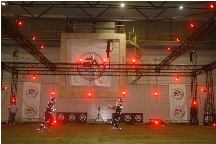
Figura 14: Distribuição descentralizada de câmeras.
