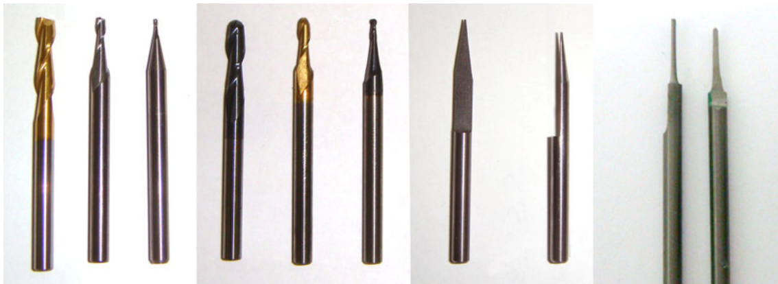
Figura 24– Tipos de fresas: topo e raiada usada para os primeiros desbastes e para as fases intermediárias de prototipagem e flat cônica e paralela para detalhes
