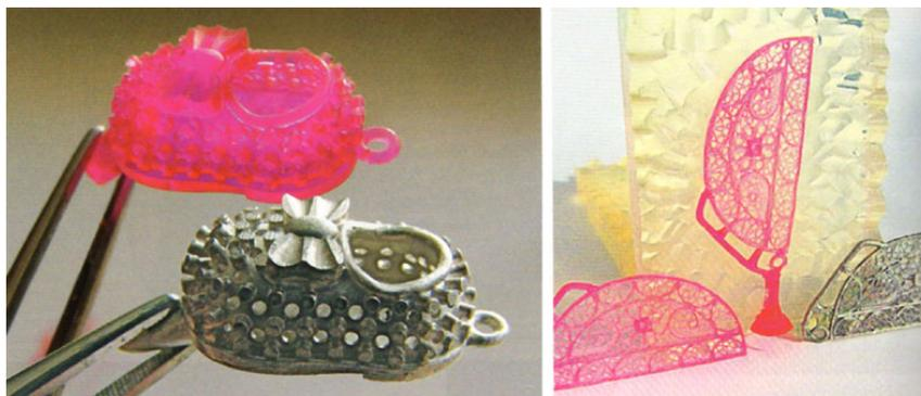
Figura 17- Tecnologia de modelos de alta definição através de fotopolímero (fonte: GZ Magazine, março de 2009, p.42)
