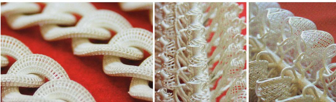
Figura 18 - peças em metal fundidas através dessas novas fundidoras que permitem a execução de detalhes e “filigranas” (fonte: folder da Topcast Engineering, 2009)
