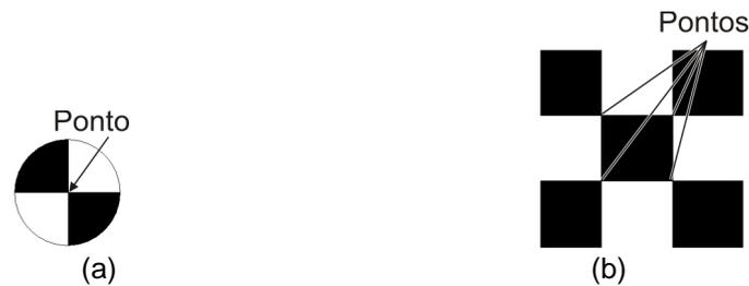
Figura 31: (a) Ponto como interseção de duas retas. (b) Grupo de pontos.
