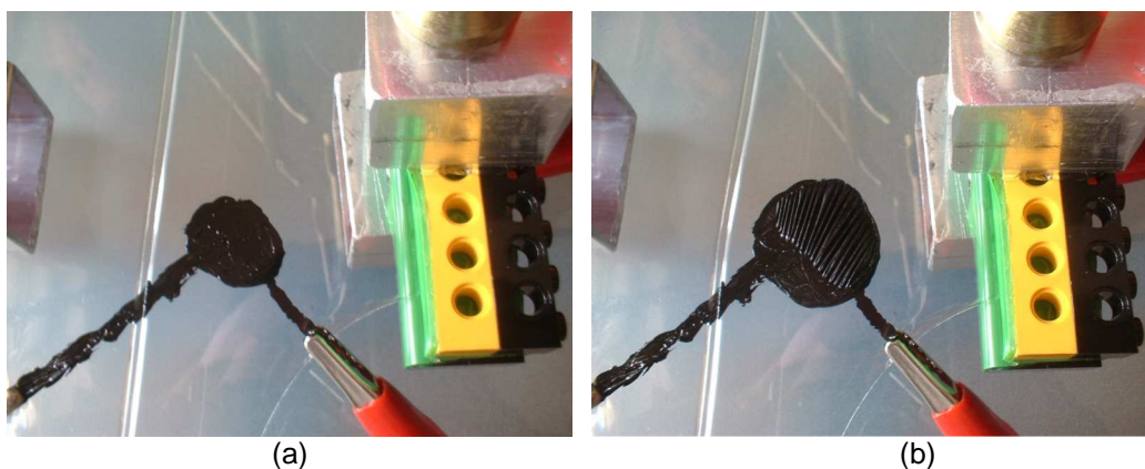
Figura 8: (a) Teste de moldura fixa com VHB 4910 sem tensão aplicada. (b) Teste de moldura fixa com VHB 4910 com tensão aplicada.
