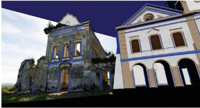
Figura 5.5: Imagem real da aplicação 3D-Pose. Casamento entre imagem e modelo de uma edificação, com linhas estruturais do modelo mostradas em azul.
