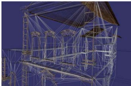
3.14(a): Modelo gerado no 3D-Studio Max® exibido em modo wireframe . Pode-se observar que paredes e forros são compostos por triângulos adjacentes que têm muitas arestas coplanares compondo uma mesma face.
