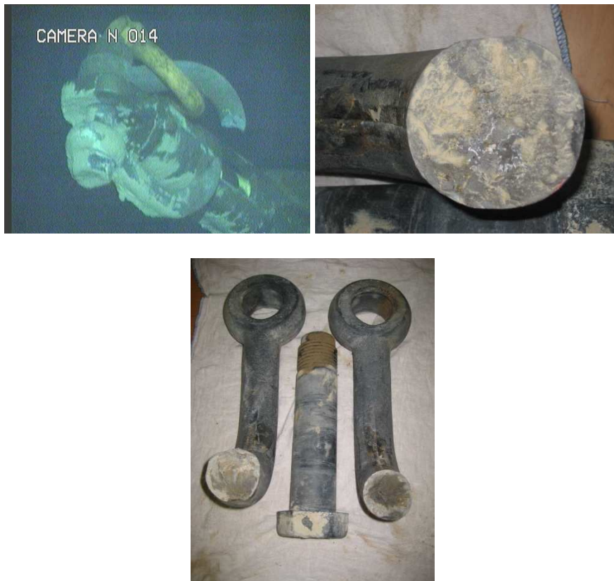
Figura 2.1 – Exemplo de manilha que apresentou fratura em operação [7].
