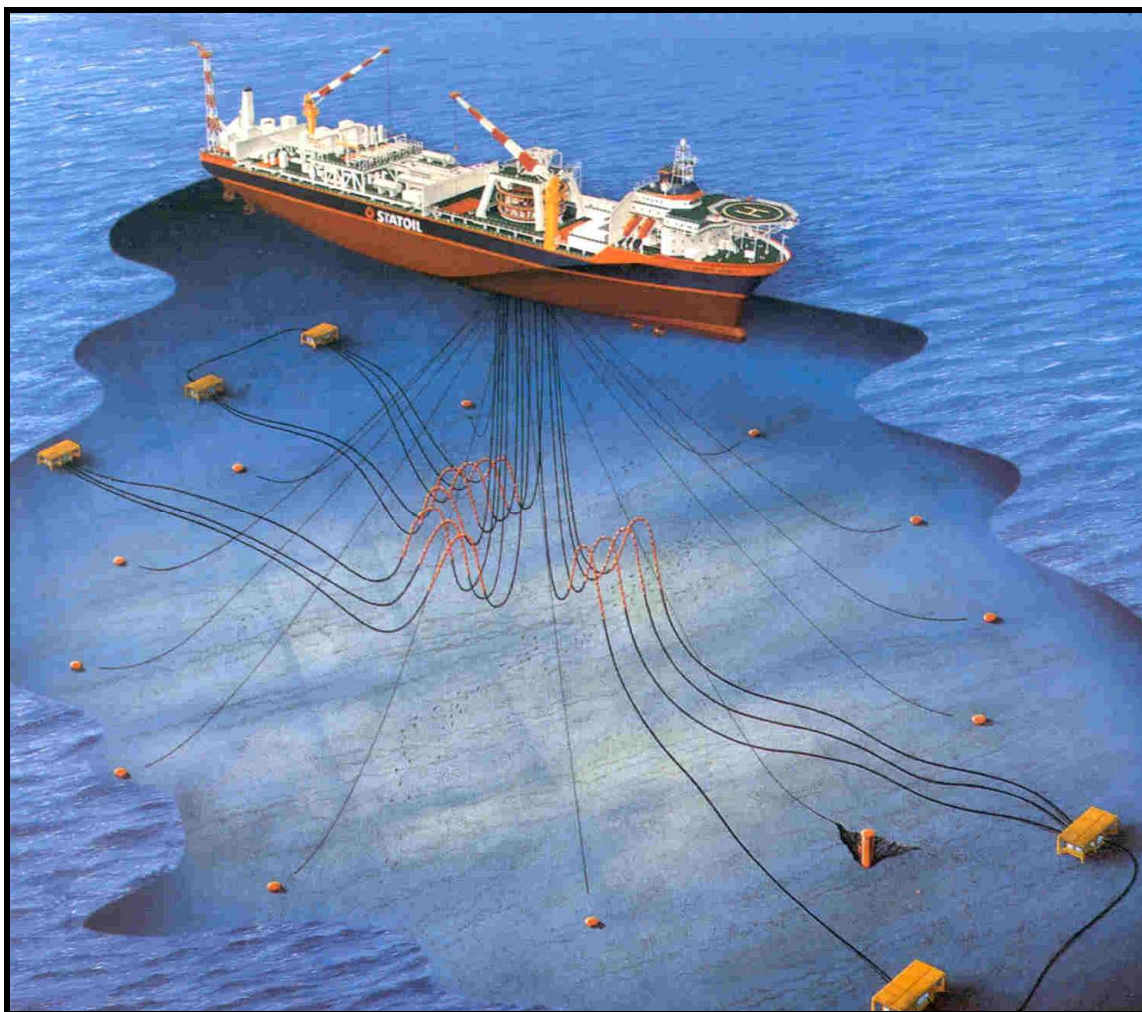
Figura 1.1 - Sistema de ancoragem e prospecção de uma unidade FPSO (Flotation Production Storage Oil) [1].
