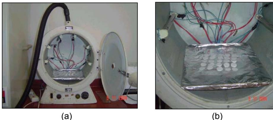
Figura 13: (a) Reator fotoquímico e (b) detalhe dos papéis sendo irradiados.
