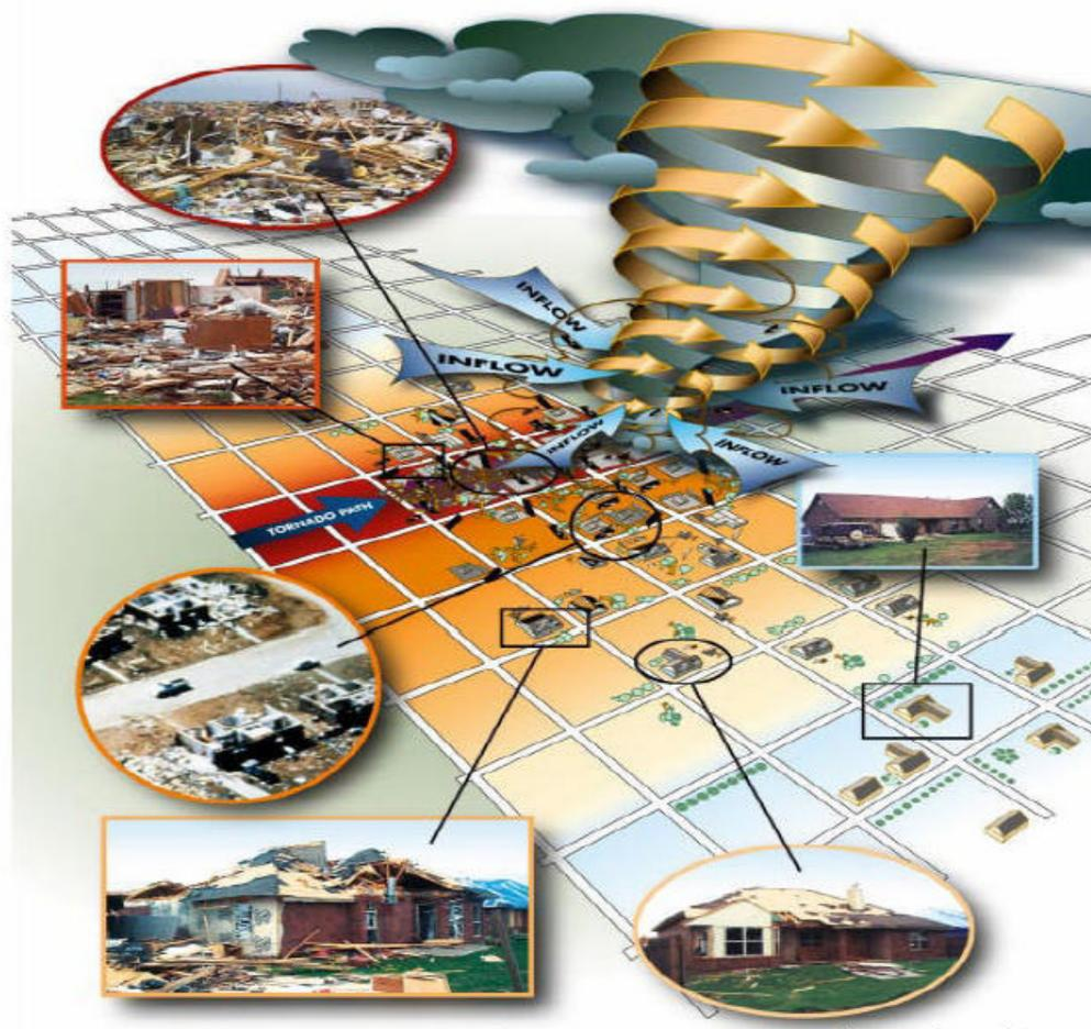
Figura 2.15 – Danos a construções em superfície causados pela velocidade radial dentro da camada limite - *Federal Emergency Management Agency, FEMA, 1999*
