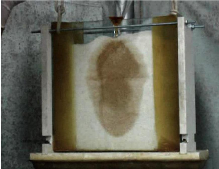
Figura 26 - Saturação do NAPL na camada do solo (esferas de vidro).
