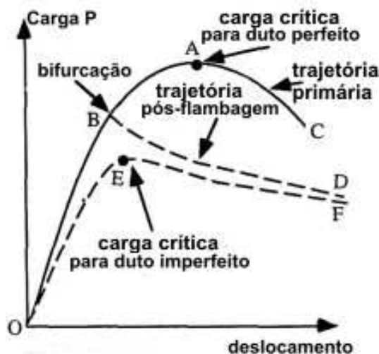
Figura 2.1: Flambagem com snap-through e/ou bifurcação para cilindros comprimidos axialmente
