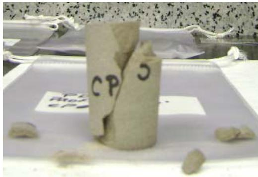
Figura 30.- Corpo de prova # 5. Logo após do ensaio UCS
