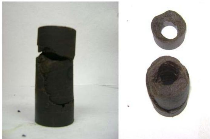
Figura 38.- Falha da rocha no ensaio do cilindro ôco
