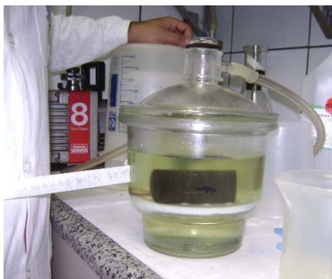
Figura 23.- Saturação das amostras. Ensaio de cilindro oco, ou *TWC*
