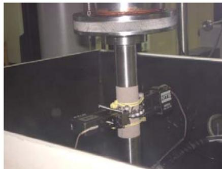
Figura 22.- Execução do ensaio de compressão uniaxial
