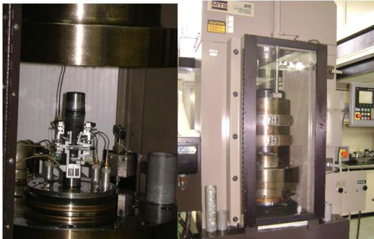
Figura 27.- Execução do ensaio de cilindro oco
