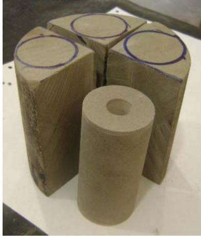
Figura 21.- Corpo de prova para os ensaio de cilindro oco
