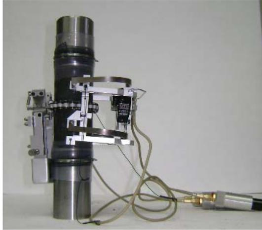
Figura 26.- Montagem dos extensômetros elétricos
