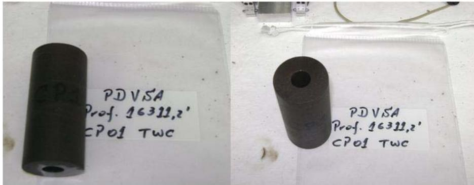
Figura 24.- Corpo de prova saturado
