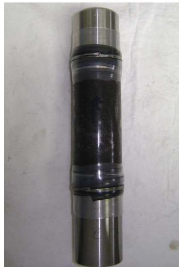
Figura 25.- Colocação dos *caps* no corpo de prova
