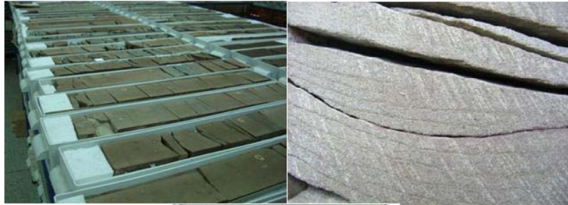
Figura 13.- Core Disking , prova dos altos gradientes horizontais na zona
