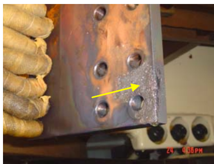
Flanges dos links de interligação apresentando carbonização, corrosão e fusão
