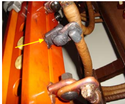
O terminal de conexão do cabo de AT encontrava-se totalmente corroído
