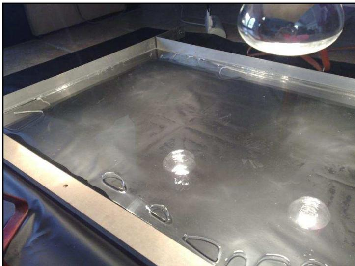
Figura 5.15 – Aplicação da parafina gel sobre a placa de acrílico.
