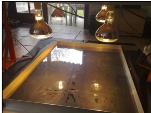
Figura 3.8 – Placa de acrílico sendo pré-aquecida por 4 lâmpadas de 250 W posicionadas sobre a placa.
