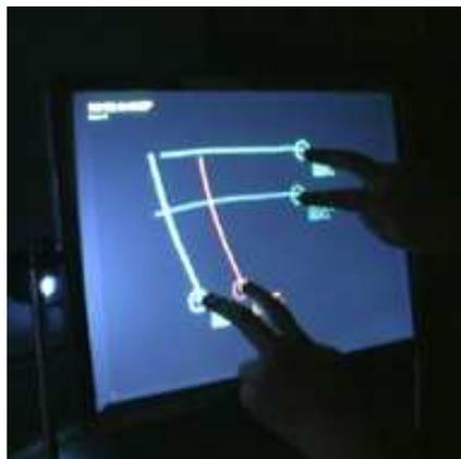
Figura 2.6 – Aspecto de uma imagem vista em um sistema *multitouch* baseado no princípio do FTIR.
