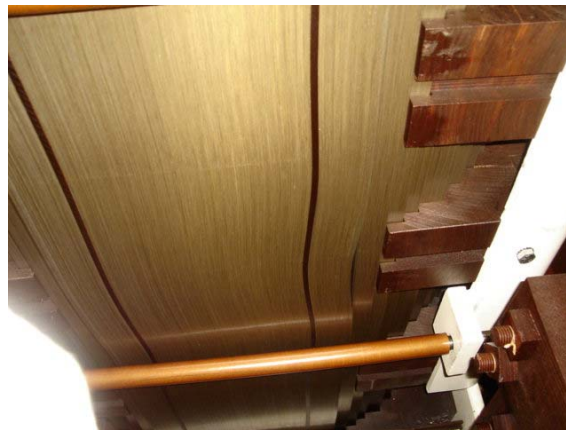
Figura 44 – Detalhe do desalinhamento do núcleo
