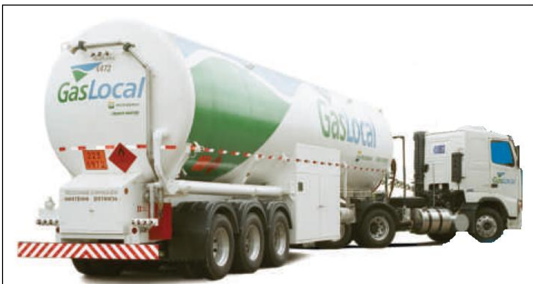
Figura 8: Caminhão com tanque criogênico (Gás Local)
