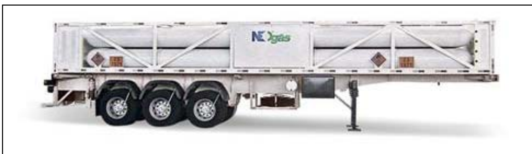
Figura 4: Carreta tubulada, capacidade nominal de 5.040 Nm 3 (Tubulão, NEO TM gás)
