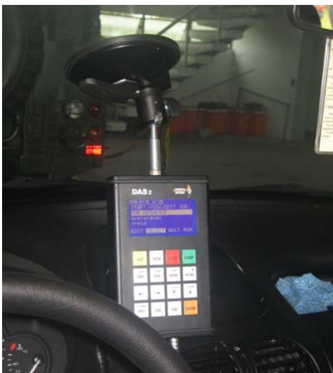
Figura 4 – Controle de aquisição de dados do equipamento Correvit .
