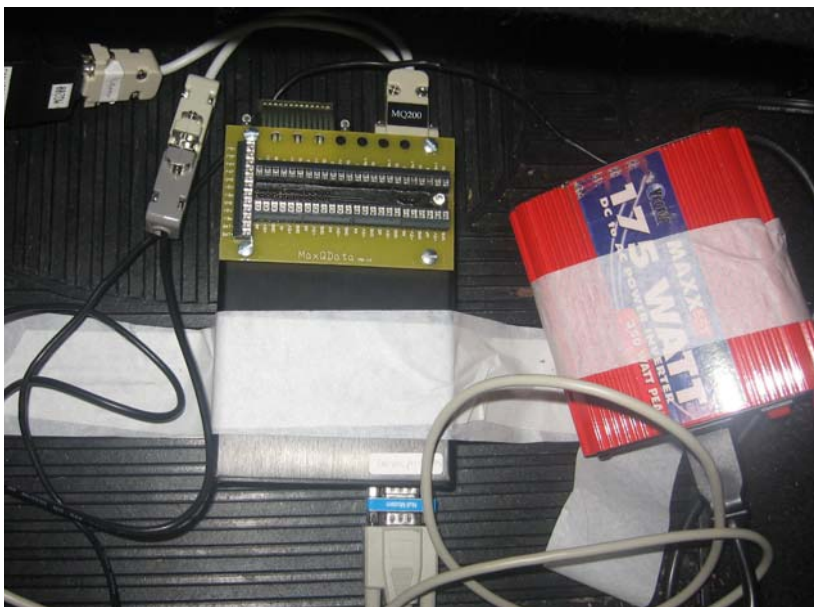
Figura 5 – Equipamento de aquisição de dados MQ200-PRO junto com transformador para alimentação de 127 V do notebook .
