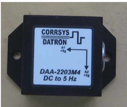
Figura 3 – Sensor de medição das acelerações conectado ao Correvit .
