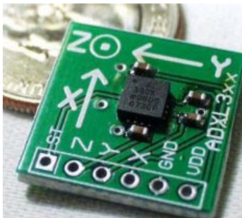
Figura 7 – Acelerômetro Capacitivo Modelo ADXL – 3 eixos.
