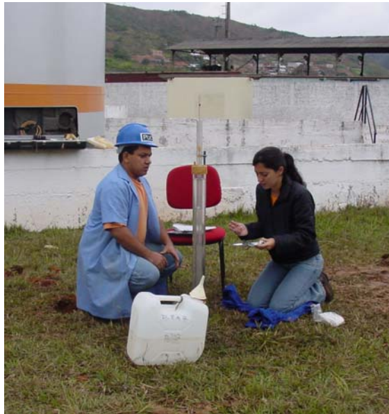
Figura 2.1 Permeâmetro de Guelph sendo empregado em um estudo hidrogeológico em Santos Dumont (MG)
