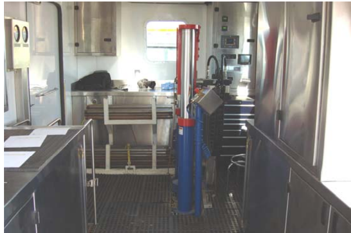
Figura 2.14 – Sistema de cravação
