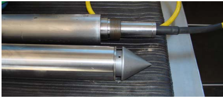
Figura 2.17 – Piezocone com medição de poropressão na posição U_2
