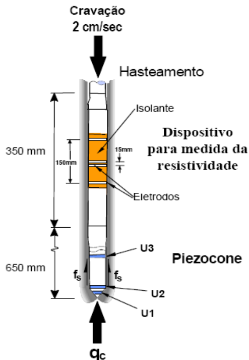
Figura 2.13 Desenho esquemático de CPTU (Davies e Campanella, 1995)
