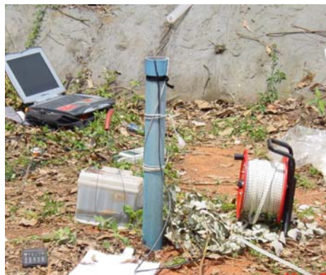
Figura 2.4 – Detalhe de um ensaio slug test realizado em uma campanha hidrogeológica em São Paulo
