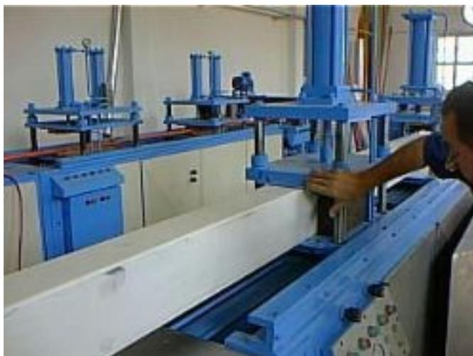
Figura 4 – Processo de pultrusão. Retirado de [www.wpp.com.br](http://www.wpp.com.br) (2005)
