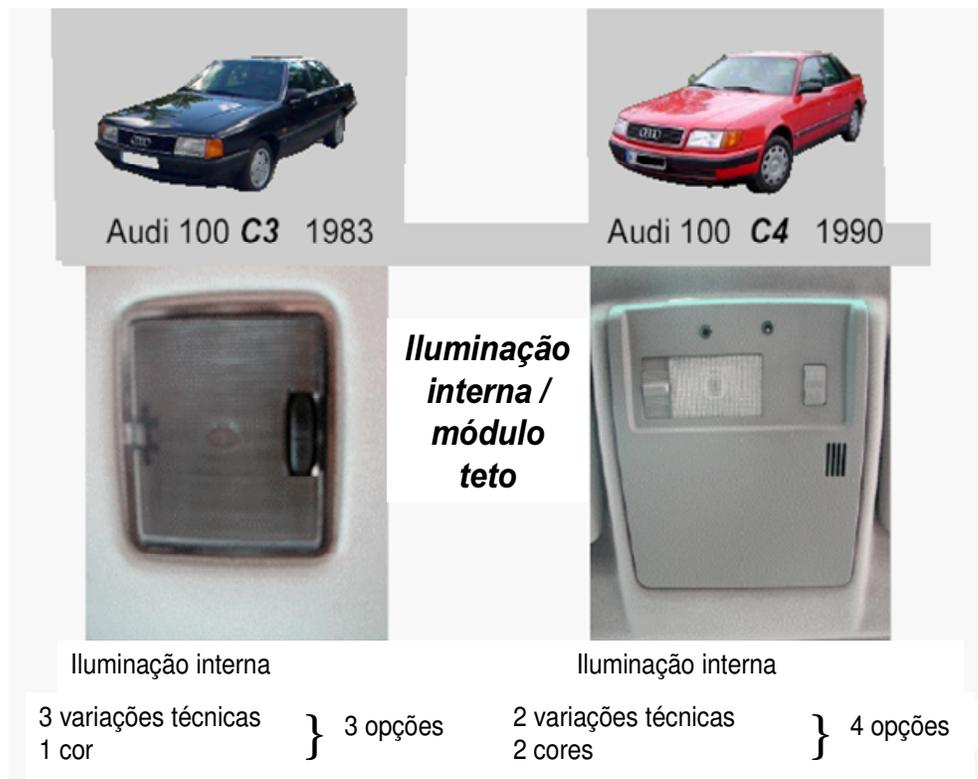
Figura 2: Variedade dinâmica para a iluminação interna do Audi C3 e C4.
