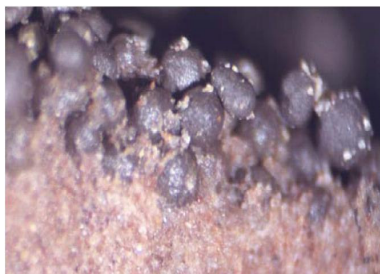
Figura 2.2 – Ilustração da penetração do propante na rocha da formação. (Barree et al. 2003).
