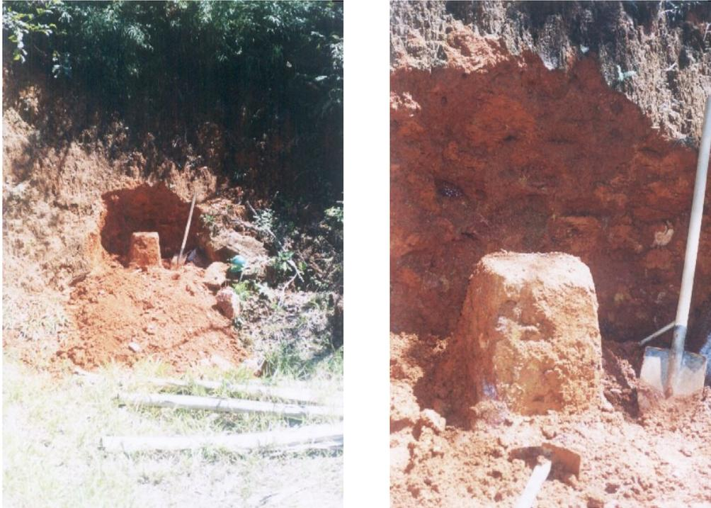
Figura 21 Coleta do bloco da encosta na variante do GASBOL.
