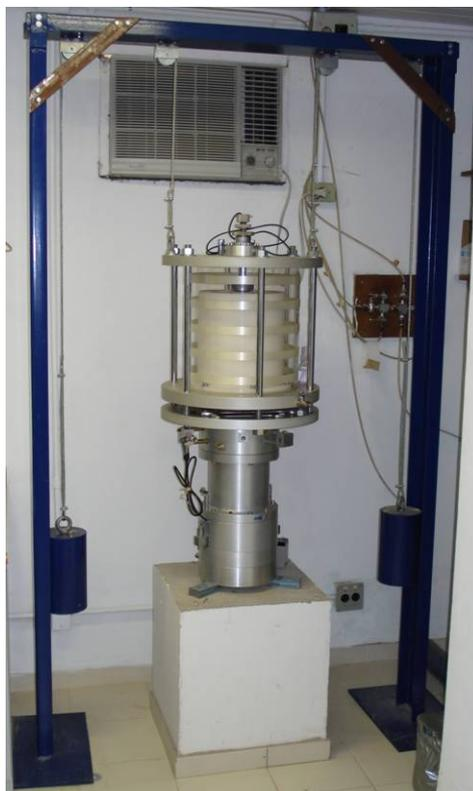
Figura 7.3 – Visão Geral do Equipamento Triaxial para Ensaios Não Saturados.
