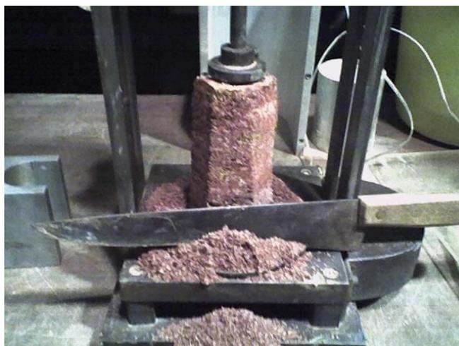
Figura 4.10 – Preparação de Corpo de Prova.
