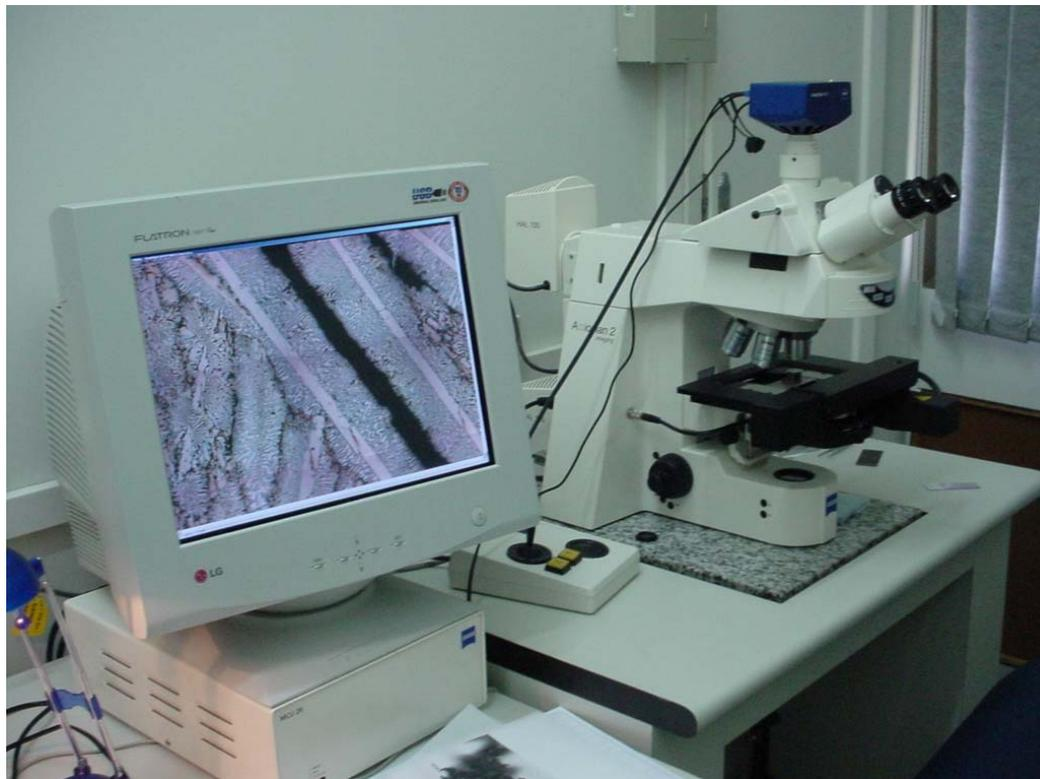
Figura 4.2 – Microscópio Óptico Zeiss AxioPlan 2IE.
