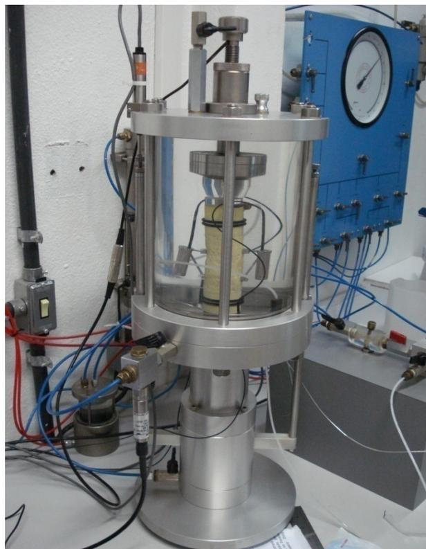
Figura 4.7 – Prensa Pneumática (*Imperial College*).
