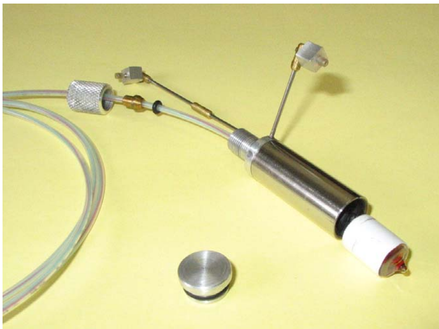
Figura 2.16 – Eletrônível tipo Imperial College desenvolvido na PUC-Rio.
