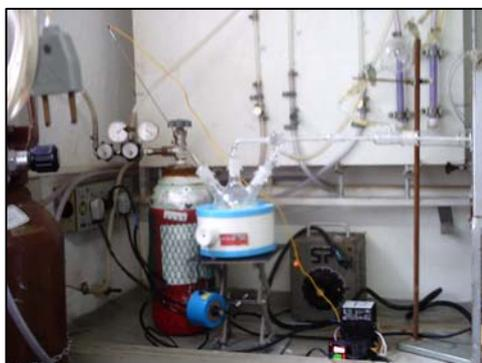
Figura 9 – Sistema de vaporização do tetracloreto de titânio.
