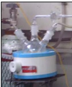
Figura 10 – Manta aquecedora - Sistema de vaporização do tetracloreto de titânio.
