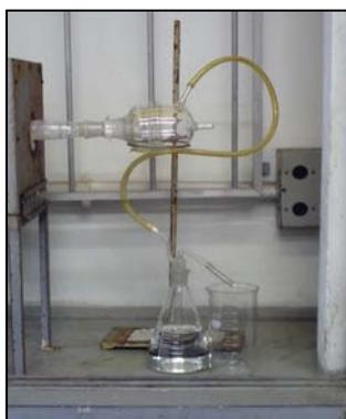
Figura 13 – Coletor de pó mais solução de  $\text{NaHCO}_3$ , para o tratamento de  $\text{HCl}$ .
