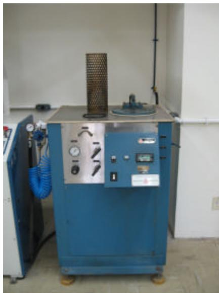
Figura 3.6 Equipamento para prensagem isostático.
