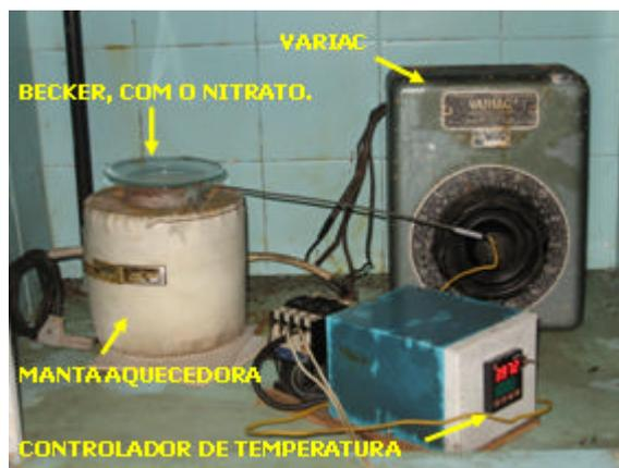
Figura 3.2. Linha experimental usada para o processo de dissociação.
