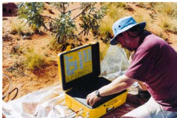
Figura 10.74 - Sismógrafo Digital ORION 3S.
