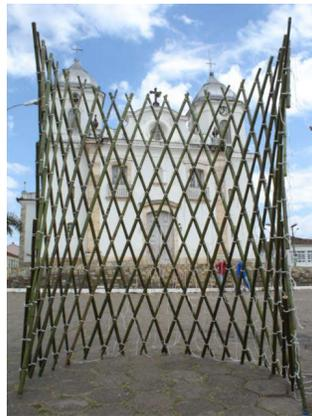
Dinâmica do sistema de treliça a partir do modelo reduzido para aplicação em escala arquitetônica<sup>81</sup>.
