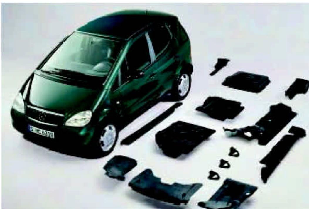
Figura 13 – Peças do modelo Classe A da Mercedes utilizando compósitos de PP reforçados com fibras de linho
