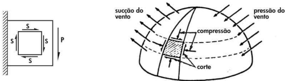
Figura 09: desenvolvimento de tensão de corte em um plano; mecanismo de corte em uma cúpula
