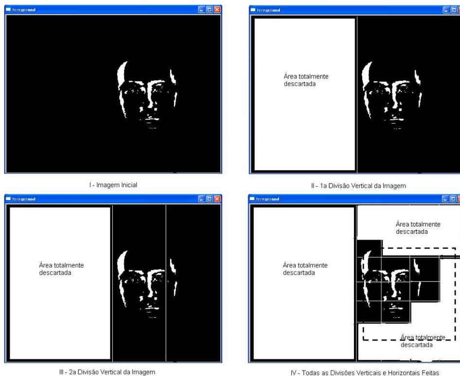
Figura 21. Heurística para o descarte de áreas sem necessidade de processamento
