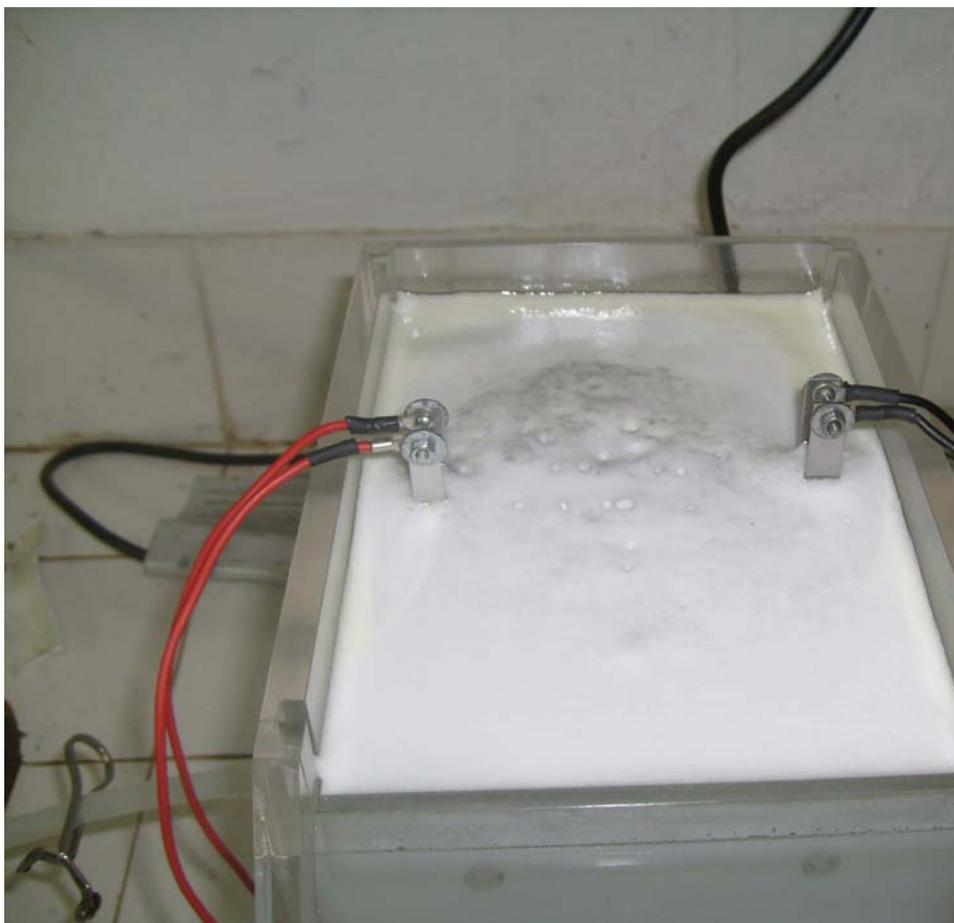
Figura 5.34: Borra com anodos de alumínio.
