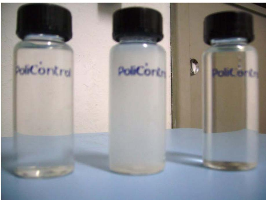
Figura 5.38: Efluente filtrado depois do tratamento (Al e Fe).
