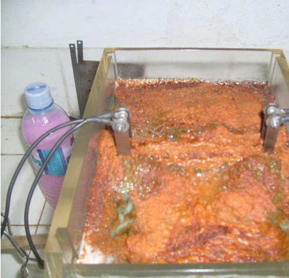
Figura 5.35: Borra com anodos de Ferro.
